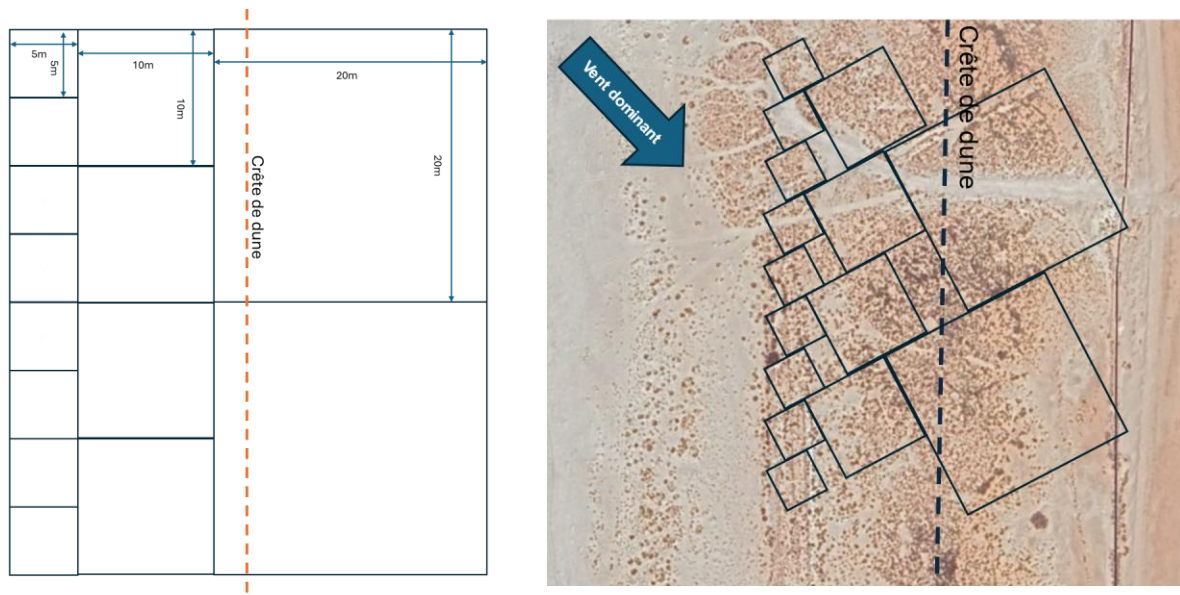
Figure 16 : à gauche : Schéma de principe de clayonnage dégressif / à droite : positionnement proposé dans le cas de Nouakchott (source : setec international / Dr Dia)
